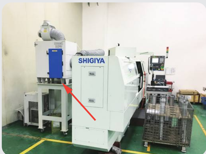
大型磨床油霧粉塵過濾
