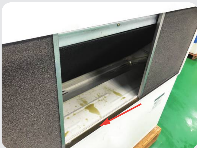
箱型冷氣進風口油霧過濾效果
