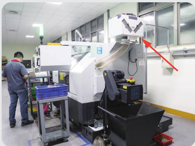
車床加工間油霧粉塵過濾
