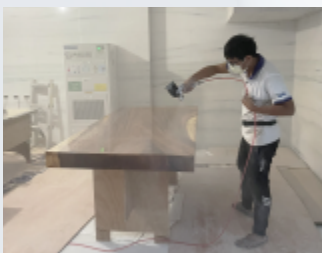
密閉空間研磨、噴漆作業降低汙染濃度。
